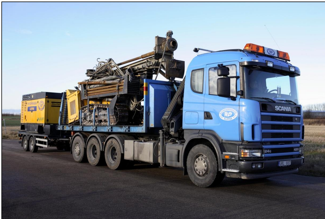
Figur 1 Borerig og kompressor på lastbil til transport.
