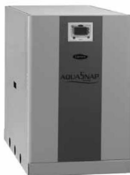
Figur 5. Eksempel på varmepumpe til varmtvands- og varmeproduktion i en større ejendom. Varmeeffekt ca. 50-100 kW. Her placeres varmtvandsbeholderen eksternt. Mål ca. 1x1x1 m. (Foto: Carrier)
