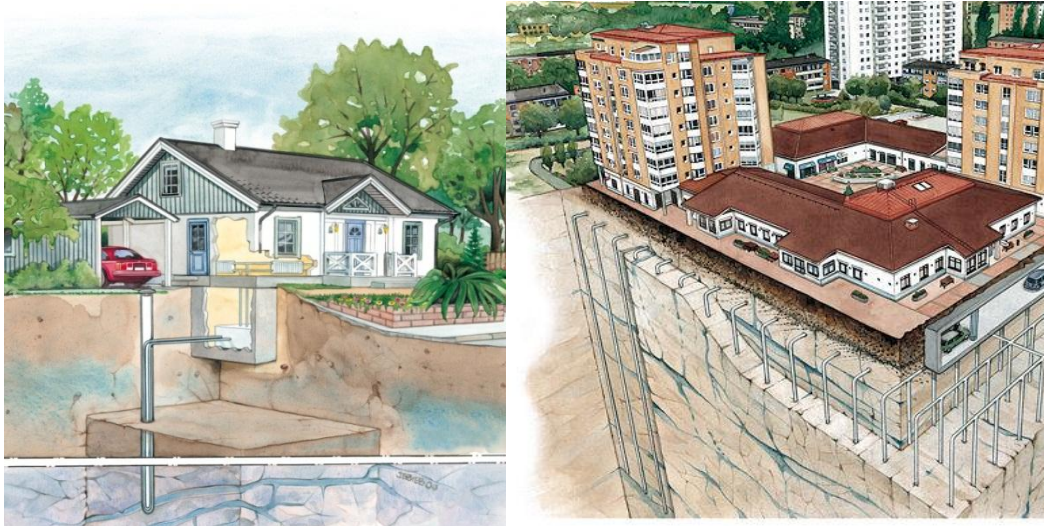
Figur 8. Fjeldvarmesystem for enfamilieshuse henholdsvis stor ejendom.
